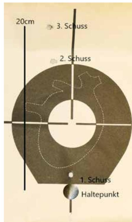
**Wird eine kombinierte Waffe zu schnell hintereinander geschossen, verschieben sich die Treffer durch die Lauferwärmung nach oben. Unbedingt Pausen einlegen!**
