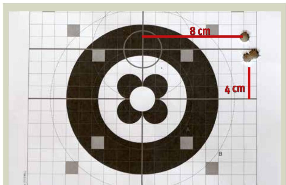
Die Treffer liegen eng beieinander, zeigen aber alle eine Abweichung nach rechts und oben. Dies kann über die Verstellmechanik des Zielfernrohrs korrigiert werden.
